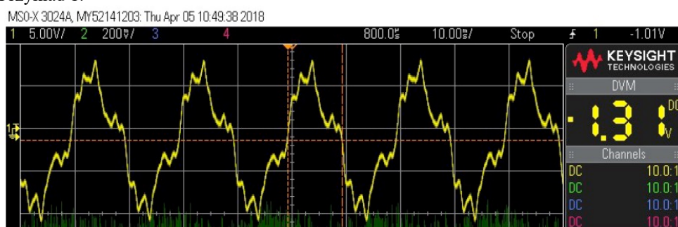
Rys. 4. Obraz z ekranu oscyloskopu. Rejestracja potencjału konstrukcji silnie zakłóconego siecią energetyczną.
