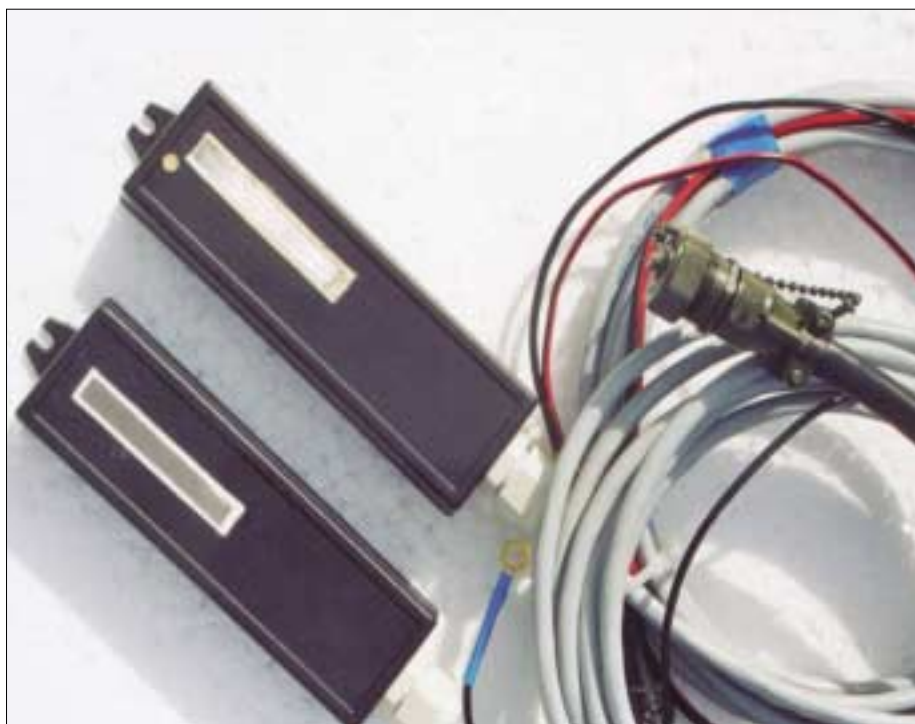
Czujniki wykorzystywane w korozymetrii rezystancyjnej do pomiaru szybkości korozji podziemnych konstrukcji stalowych - nowa metoda oceny skuteczności ochrony katodowej
