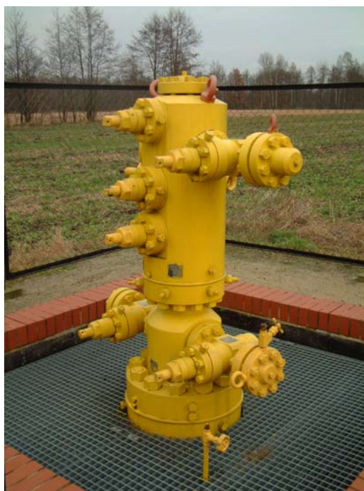
Rys. 2. Odwiert gazowy, część napowierzchniowa, bez orurowania zewnętrznego
