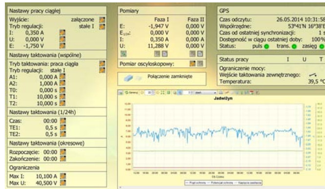
Rys. 2. Przykładowy widok ekranu stacji ochrony katodowej MSOK-02
