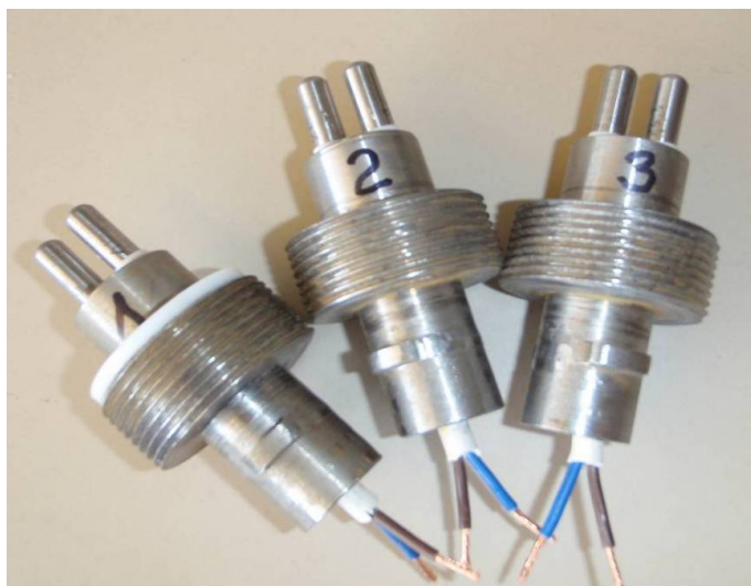
Rys. 6. Sondy bi-elektrodowe z elektrodami stalowymi
