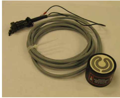
Fot. 5–6. Pierwotny czujnik szybkości korozji (po lewej) i obecnie używany czujnik korozymetryczny
