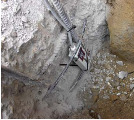
Fot. 5–6. Pierwotny czujnik szybkości korozji (po lewej) i obecnie używany czujnik korozymetryczny
