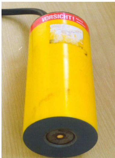
Rys. 2. Budowa sondy korozyjnej Baeckmanna
