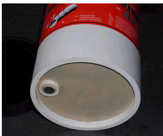
Rys. 8. Widok sondy korozyjnej z elektrodą symulującą o powierzchni 1\text{ cm}^2 wbudowaną w przegrodę ceramiczną elektrody odniesienia
