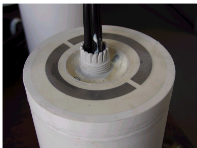
Rys. 4. Widok sondy korozyjnej z dwiema elektrodami symulującymi 2 x 10 cm 2
