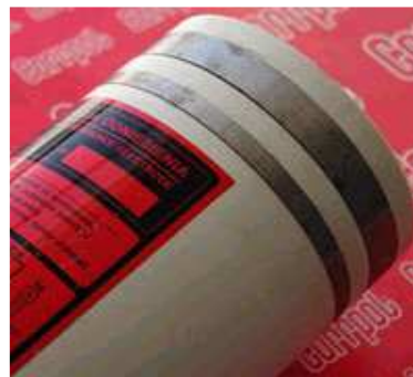
Rys. 7. Widok sondy korozyjnej z dwiema pierścieniowymi elektrodami symulującymi
