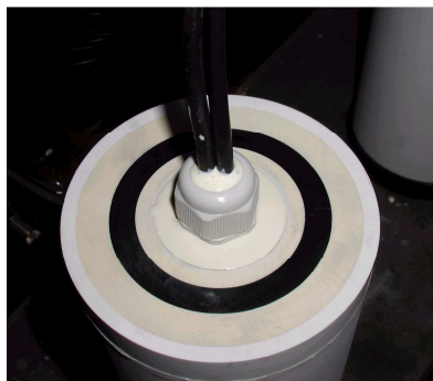
Rys. 6. Widok sondy korozyjnej z jedną pierścieniową elektrodą symulującą ( 20\text{ cm}^2 )
