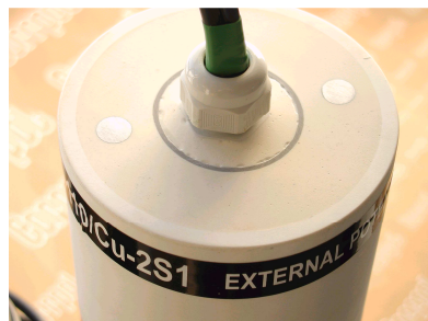
Rys. 5. Widok sondy korozyjnej z dwiema elektrodami symulującymi 2 x 1 cm 2
