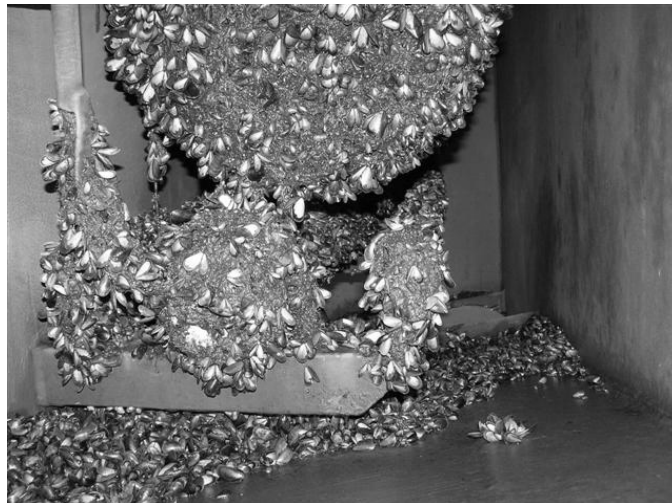
Rys. 1. Przykład intensywności porastania chłodnicy zaburtowej w obszarze Morza Północnego po 1 roku eksploatacji [źródła własne]
