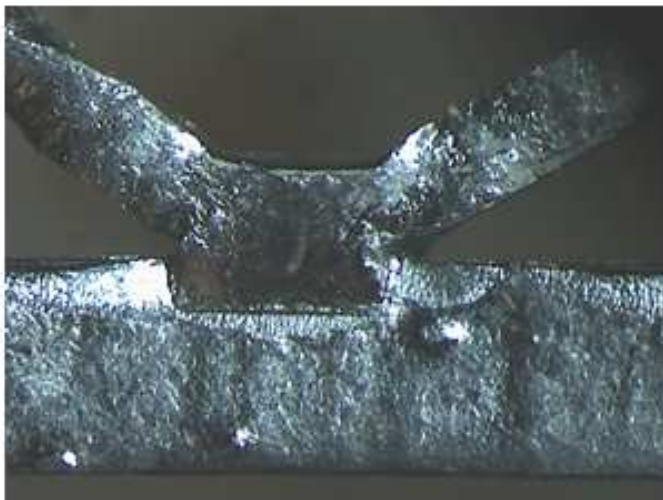
Struktura powierzchni kratki w powiększeniu 10x przed badaniami odpornosci korozyjnej
