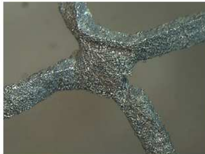
Struktura powierzchni kratki w powiększeniu 10x po badaniach odpornosci korozyjnej i trawieniu
