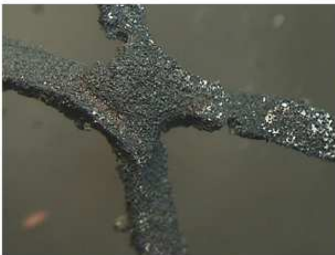
Struktura powierzchni kratki w powiększeniu 10x po badaniach odpornosci korozyjnej i trawieniu
