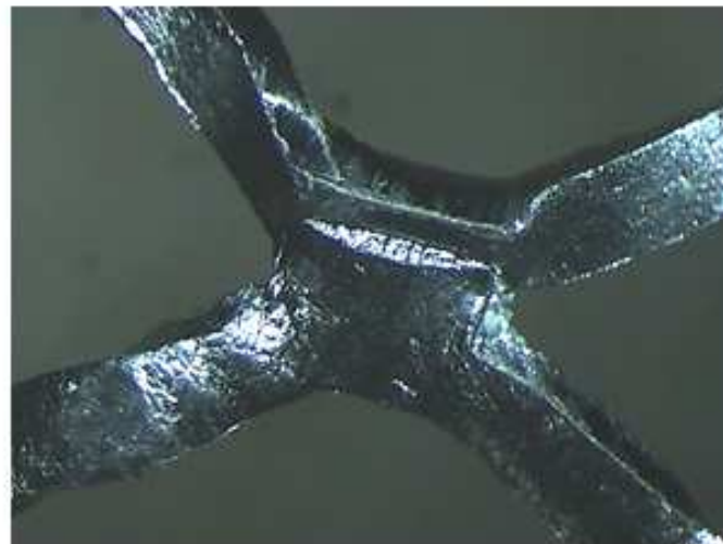
Struktura powierzchni kratki w powiększeniu 10x przed badaniami odpornosci korozyjnej
