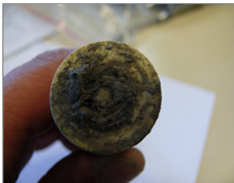
Rys. 13. Widok stalowej powierzchni symulującej czujnika korozymetrycznego o powierzchni 1 \text{ cm}^2 zdemontowanego w maju 2014 roku w punkcie pomiarowym 8,40 km przed zdjęciem warstwy osadów i po oczyszczeniu powierzchni z osadów
