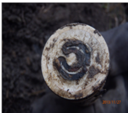
Rys. 12. Widok stalowej powierzchni czujnika korozymetrycznego o powierzchni 1 \text{ cm}^2 zdemontowanego w listopadzie 2013 roku w punkcie pomiarowym 8,40 km po stwierdzeniu przyspieszonej korozji
