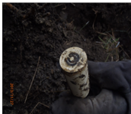
Rys. 12. Widok stalowej powierzchni czujnika korozymetrycznego o powierzchni 1 \text{ cm}^2 zdemontowanego w listopadzie 2013 roku w punkcie pomiarowym 8,40 km po stwierdzeniu przyspieszonej korozji
