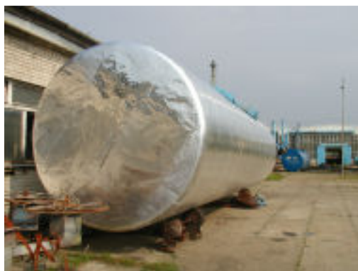
Fot. 1 i 2. Zbiornik stalowy owinięty (pokryty) folią aluminiową przed laminowaniem oraz gotowy zbiornik dwupłaszczowy po wykonaniu zewnętrznej warstwy laminatu. Photo 1 and 2. Steel tank wrapped (covered) with aluminium foil before laminating and the ready double-walled tank after performing an exterior laminate layer.
