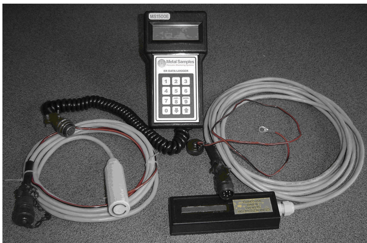
Rys. 6. Korozymetr rezystancyjny oraz rezystancyjne czujniki korozymetryczne o powierzchni 1\text{ cm}^2 (walcowy) i 5\text{ cm}^2 (prostokątny)
