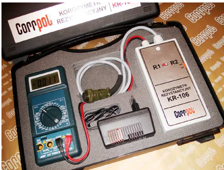
Rys. 2. Przenośny korozymetr KR-106 w formie przystawki do multimetru
