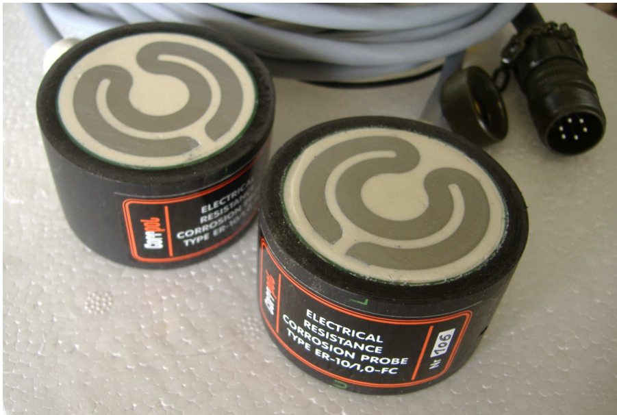
Rys. 1. Czujniki korozymetryczne rezystancyjne typu ER-10/1,0-FC prod. SPZP CORRPOL
