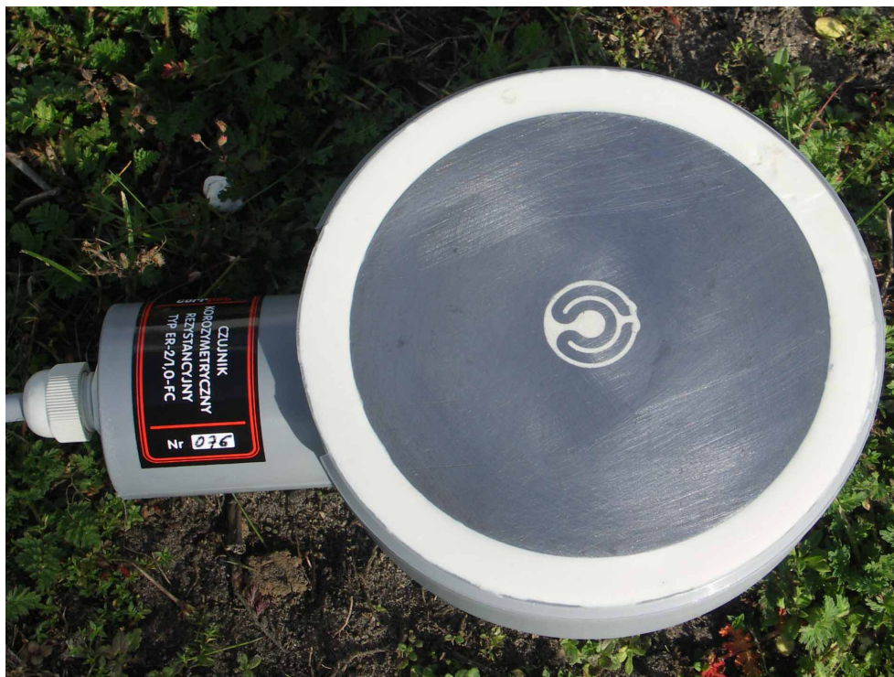
Rys. 1. Rezystancyjny czujnik korozymetryczny symulujący duży defekt powłoki izolacyjnej
