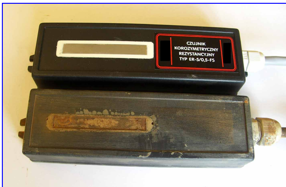
Rys. 3e). Czujnik korozymetryczny o powierzchni 5 \text{cm}^2 i grubości 0,5 mm: - na górze - nowy, przed montażem, - na dole - wyjęty po sześciu latach ekspozycji z rury otaczającej zwartej z rurą przewodową
