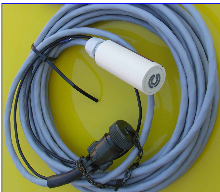
Rys. 8. Czujnik korozymetryczny o powierzchni 1 \text{ cm}^2 stosowany m.in. w monitorowaniu zagrożenia korozją przemiennoprądową oraz korozją powodowaną przez prądy błądzące
