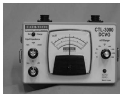
Fig. 14. Analogue DCVG meter
