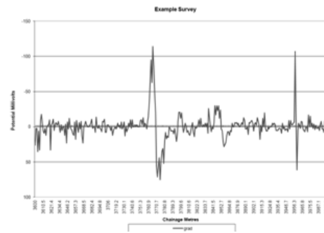
Fig. 10. DCVG survey data
