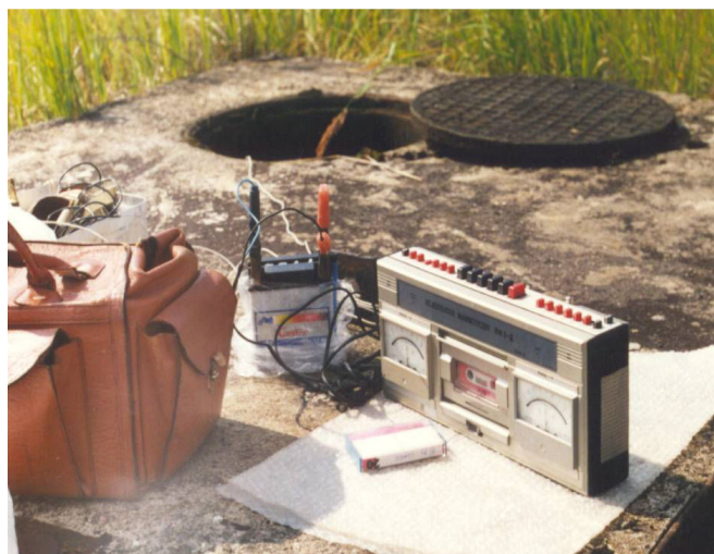
Fot 1. i Fot. 2. Pierwszy rejestrator magnetyczny RM2-I[11] i jego następcą RM3-2 podczas prac w terenie.
